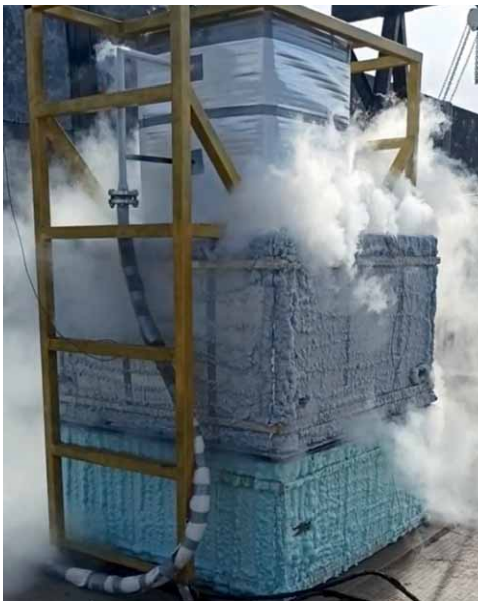
Рисунок 2. Стенд для испытания на криогенный пролив по методике ISO 20088-1, собранный сотрудиниками ВНИИПО МЧС России Источник: «ОЗ-Коутингс»
